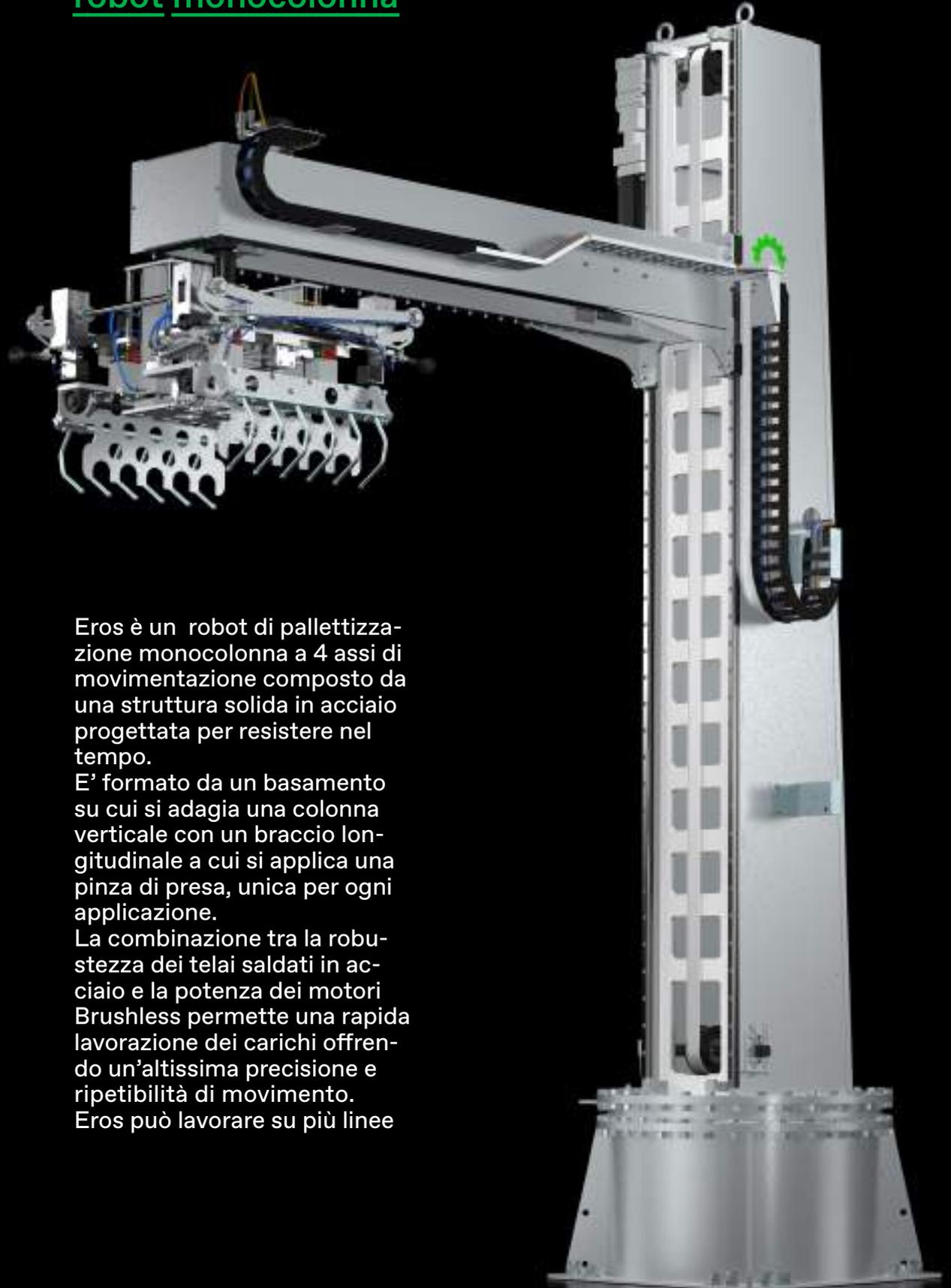
Eros è un robot di pallettizzazione monocolonna a 4 assi di movimentazione composto da una struttura solida in acciaio progettata per resistere nel tempo.
